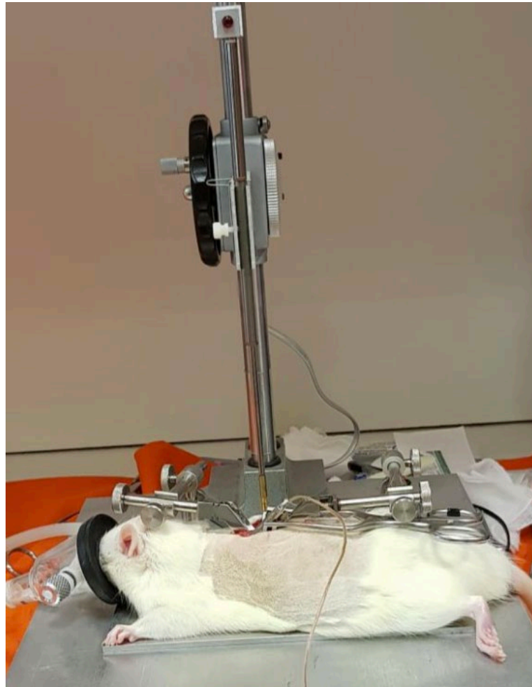
Figura 3 - Impacto medular através do NYU Impactor
