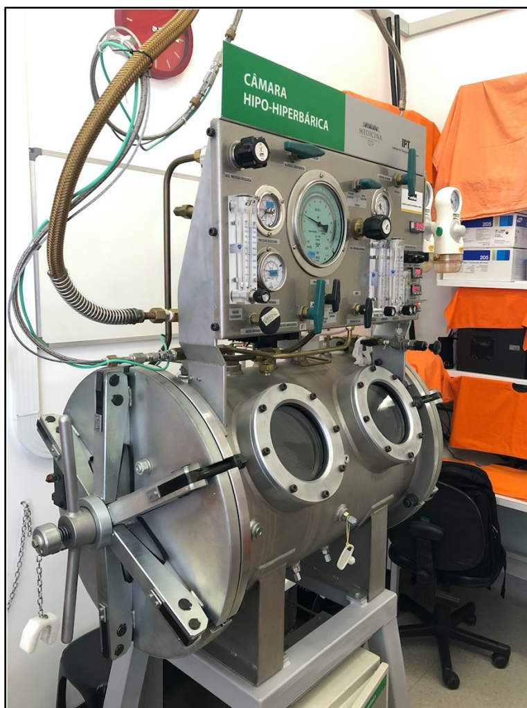
Figura 8. Câmara hiperbárica experimental. Fonte: arquivo pessoal.
